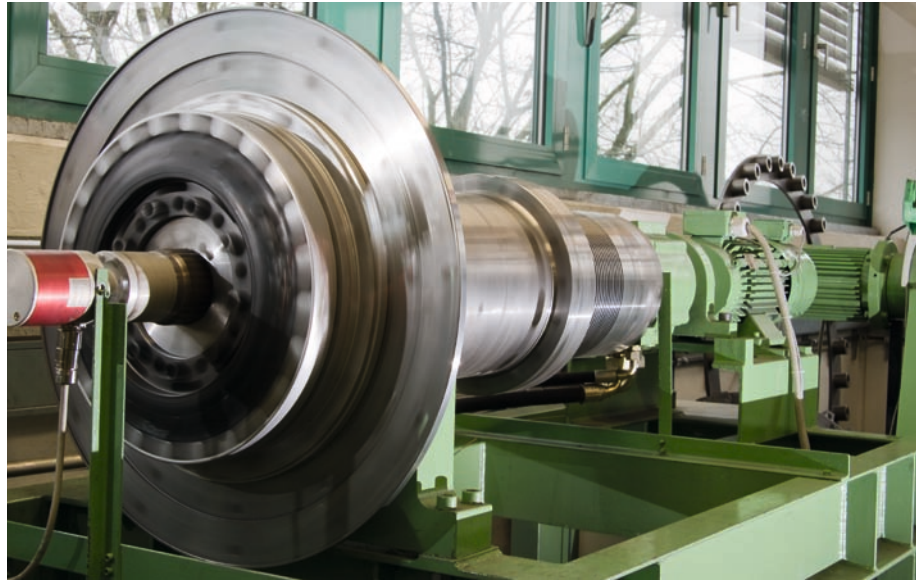
Dynamic testbench for determining of allowable energy loss. Dynamischer Prüfstand zur Bestimmung der zulässigen Verlustleistung.
